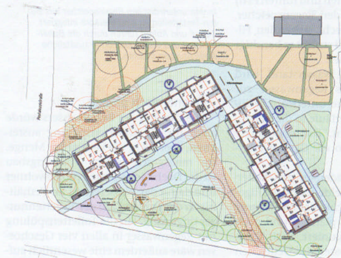
Die im Plan blau eingezeichneten Zisternen von Mall sind beim linken Häuserblock je 8 und rechts 12 Wohneinheiten zugeordnet.
